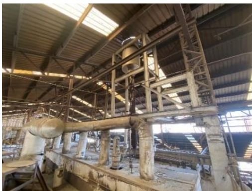
รูปที่ 43 วัสดุครอบปิดแหล่งกำเนิดเสียงดัง
